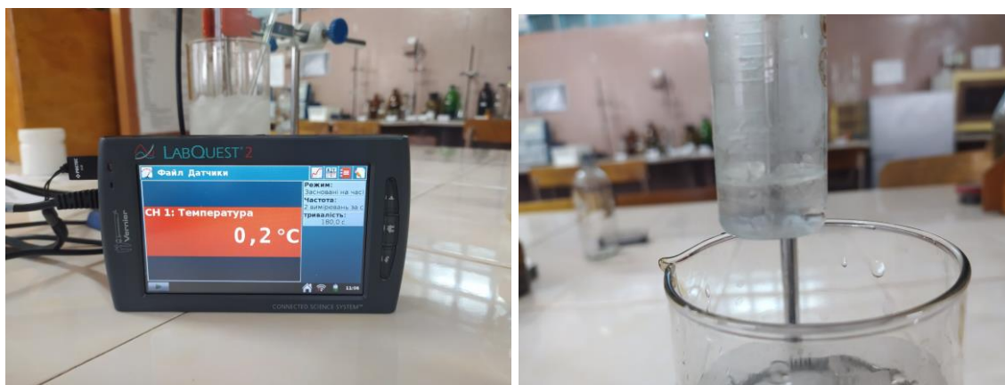
Рис. 8. Фіксація даних датчика температури: а) температура замерзання води, б) утворення льоду під час замерзання
