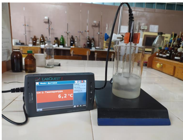
Рис. 5. Вимірювання температури рідини за допомогою датчика температур і реєстратора даних цифрової лабораторії LabQuest 2
