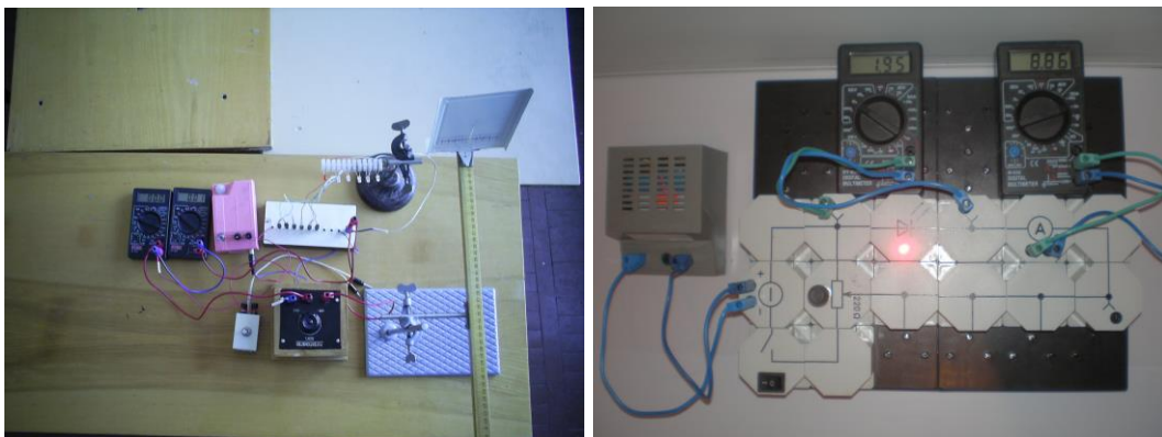
Рис. 5.5 Загальний вигляд установки для визначення сталої Планка.
