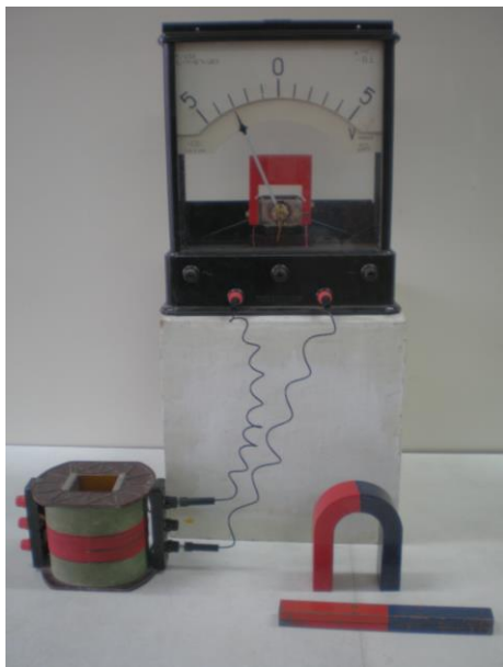
Рис. 37. Залежність ЕРС індукції від швидкості зміни магнітного поля
