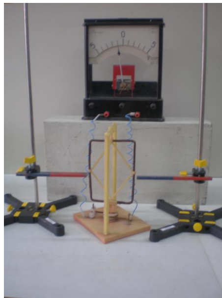
Рис. 39. Утворення змінного струму у витку під час його обертання в магнітному полі.
