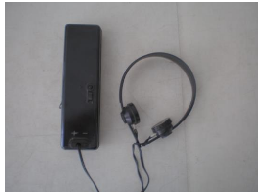
Рис. 57 . Індикатори іонізуючих частинок демонстраційний і лабораторний.
