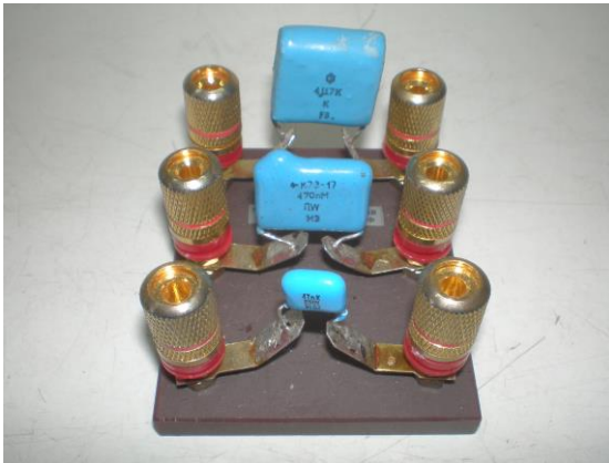
Рис. 30. Батареї керамічних і паперових конденсаторів.
