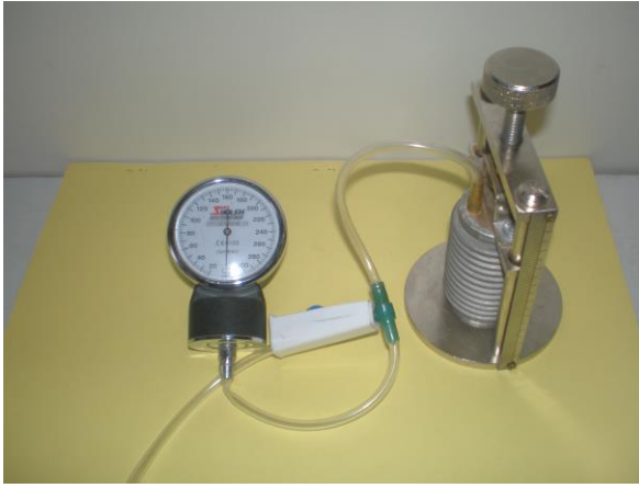
Рис. 66. Лабораторні установки для вивчення газових законів та експериментальної перевірки рівняння стану газу.
