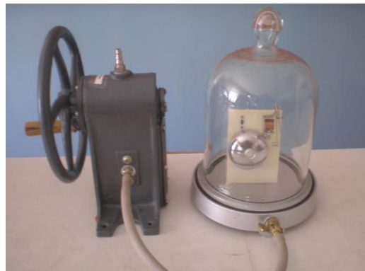
Рис. 47. Роль пружного середовища в поширенні звуку.
