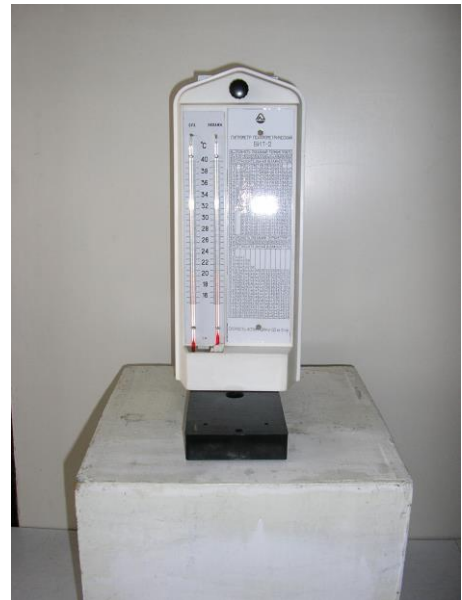
Рис. 19. Психрометр з психрометричною таблицею
