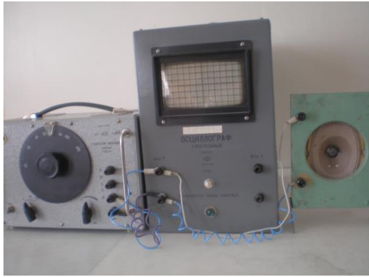
Рис. 48 і 49 . Установки для демонстрацій залежності гучності звуку від амплітуди коливань та висоти тону від частоти коливань.
