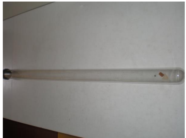
Рис. 9. Демонстраційна установка демонстрації напрямку швидкості при русі по колу
