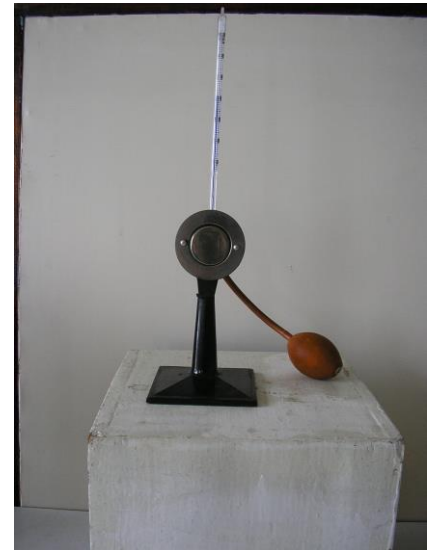
Рис. 19. Психрометр з психрометричною таблицею
