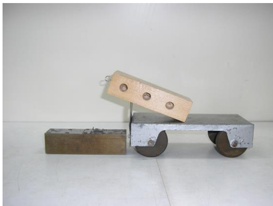
Рис. 13. Демонстрація першого закону Ньютона.
