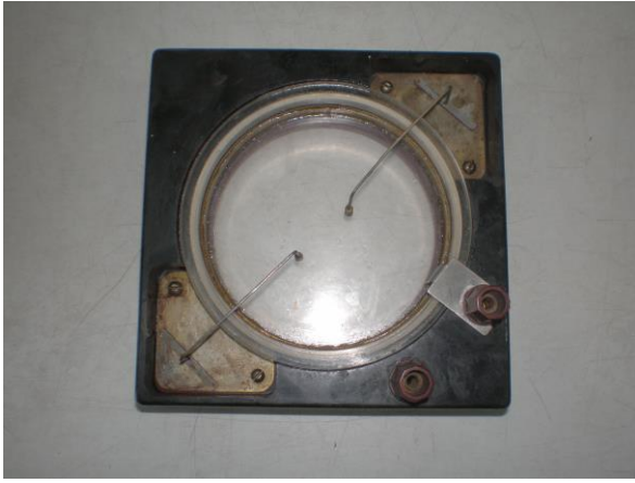
Рис. 29. Прилад для демонстрування силових ліній електричних полів для точкових зарядів і плоского конденсатора.
