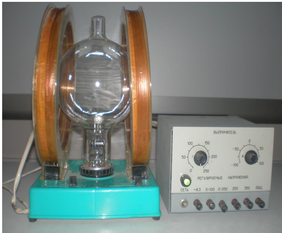
Рис. 35. Відхилення електронного пучка магнітним полем. .
