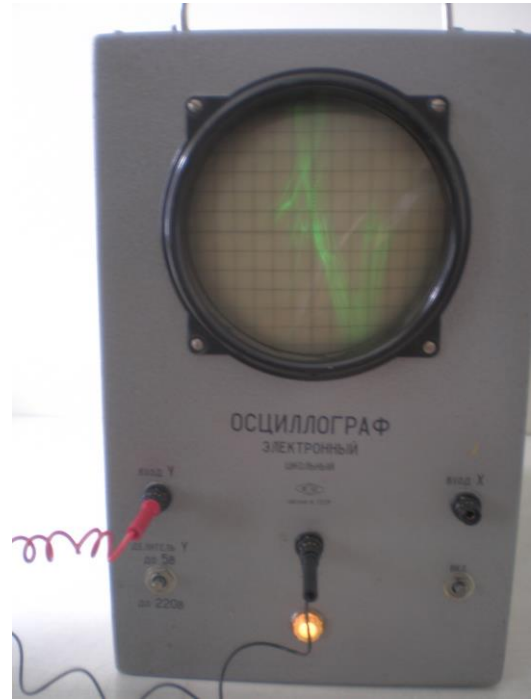
Рис. 40. Осцилограмми струму промислової частоти і від магнітоелектричної машини.
