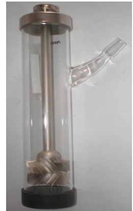
Рис. 26. Зміна внутрішньої енергії повітря внаслідок Виконання ним роботи.
