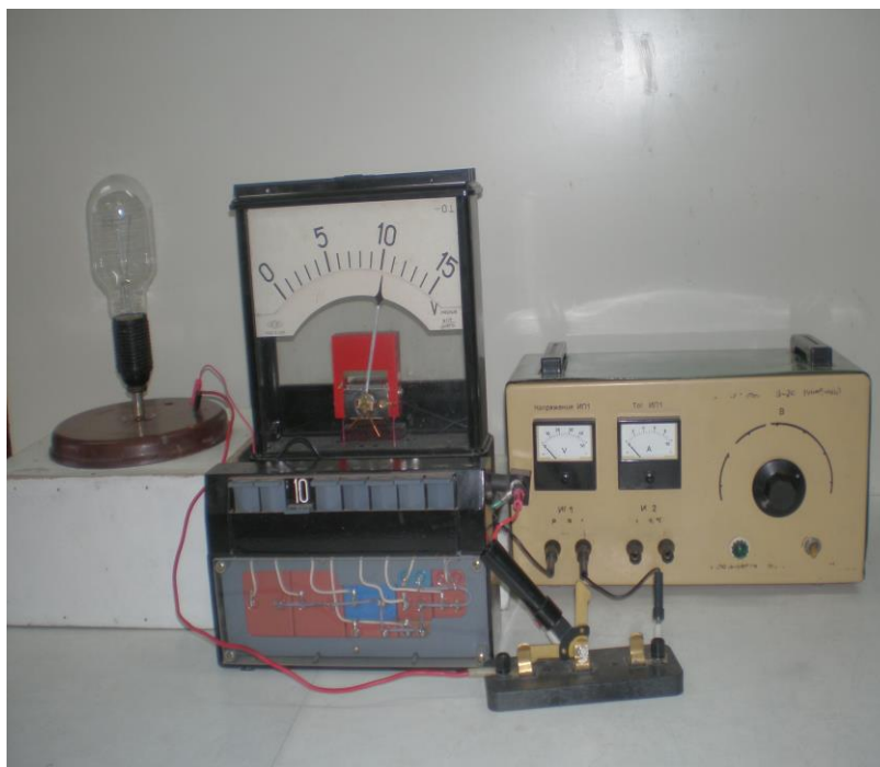
Рис. 32. Установка для демонстрації енергії зарядженого конденсатора.
