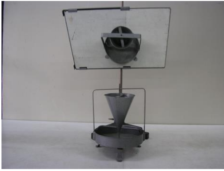
Рис. 16. Демонстрація реактивного руху з сегнеровим колесом і моделлю ракети.
