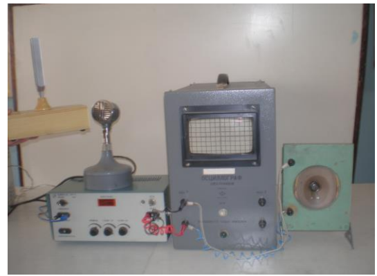
Рис. 48 і 49 . Установки для демонстрацій залежності гучності звуку від амплітуди коливань та висоти тону від частоти коливань.
