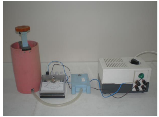
Рис. 66. Лабораторні установки для вивчення газових законів та експериментальної перевірки рівняння стану газу.
