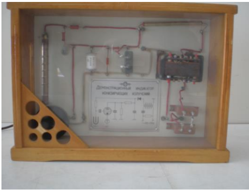
Рис. 57 . Індикатори іонізуючих частинок демонстраційний і лабораторний.
