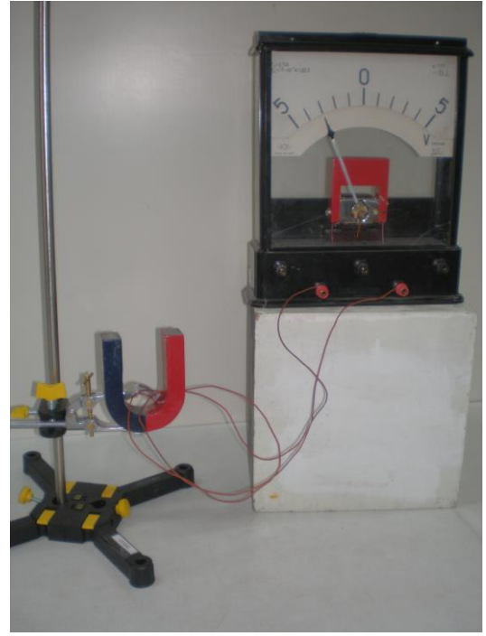
Рис. 36. Демонстрація явища електромагнітної індукції
