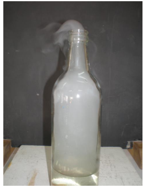
Рис. 26. Зміна внутрішньої енергії повітря внаслідок Виконання ним роботи.
