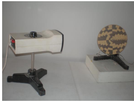
Рис. 7. Обертання тіла з різною частотою: магнітів на диску і стробоскопічного диска.
