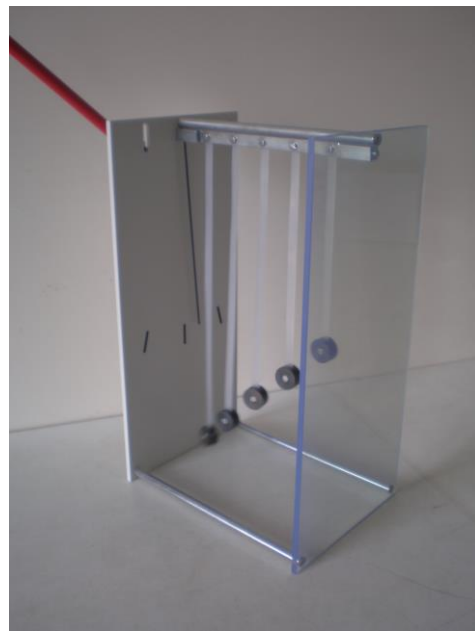
Рис. 43. Прилад для демонстрування механічного резонансу.
