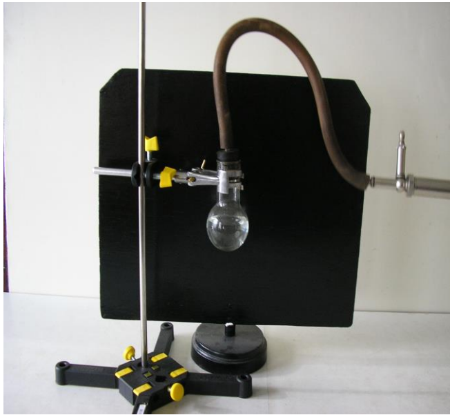
Рис. 17. Демонстрація кипіння води за зниженого тиску.
