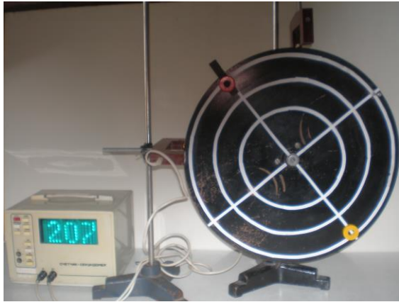
Рис. 7. Обертання тіла з різною частотою: магнітів на диску і стробоскопічного диска.
