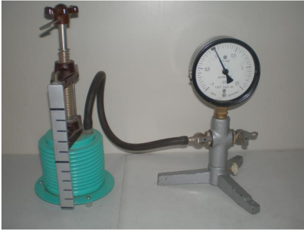
Рис. 25. Прилад Калімуліна Для демонстрації газових законів
