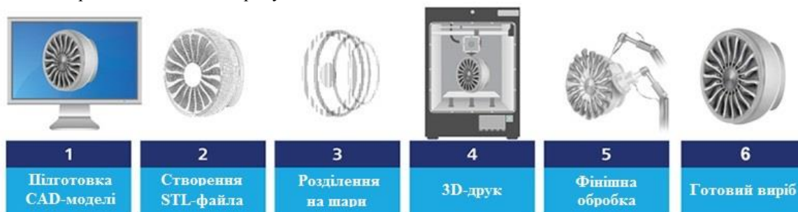
Рис. 1. Схема адитивної технології
