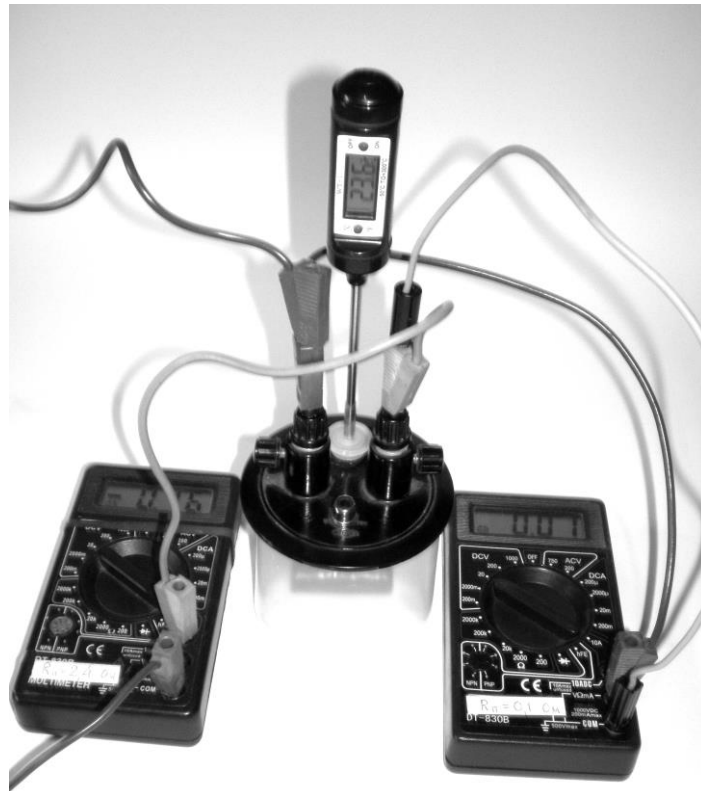
Рис. 1. Експериментальна установка до лабораторної роботи «Визначення ККД електронагрівника»
