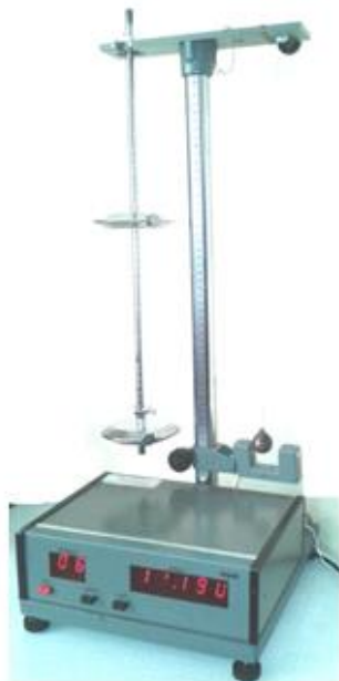
Рис. 1. Пристрій для дослідження коливань математичного та фізичного маятників FPM-03
