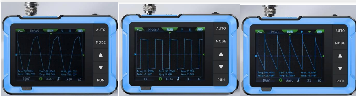
Рис. 2. Приклади форм сигналів FNIRSI DSO-510
