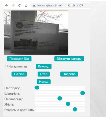
Web-інтерфейс керування з потоковою передачею відеосигналу робо-платформи на основі ESP32-CAM
