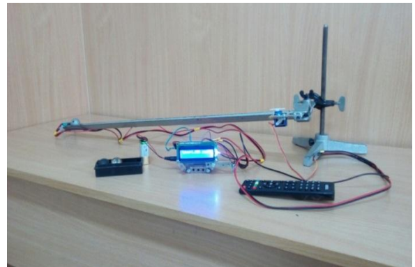
Рис. 1. Установка для вимірювання часу рівноприскореного руху.
