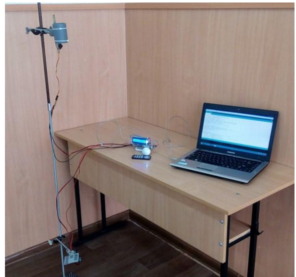
Рис. 2. Установка для дослідження прискорення вільного падіння.
