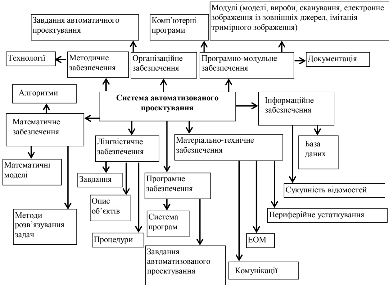
Рис. 13. Структурно-логічна схема системи автоматизованого проектування
