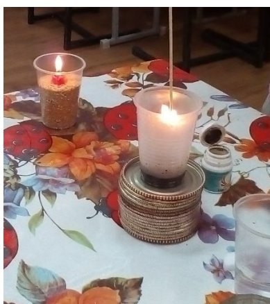
Рис. 3. Як запалити тліючу лучину. Обладнання: свічка, сірники, перекис водню, марганцівка, пластиковий стакан.
