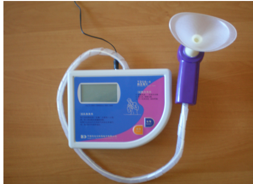
Рис. 3. Спірометр сухий портативний.
