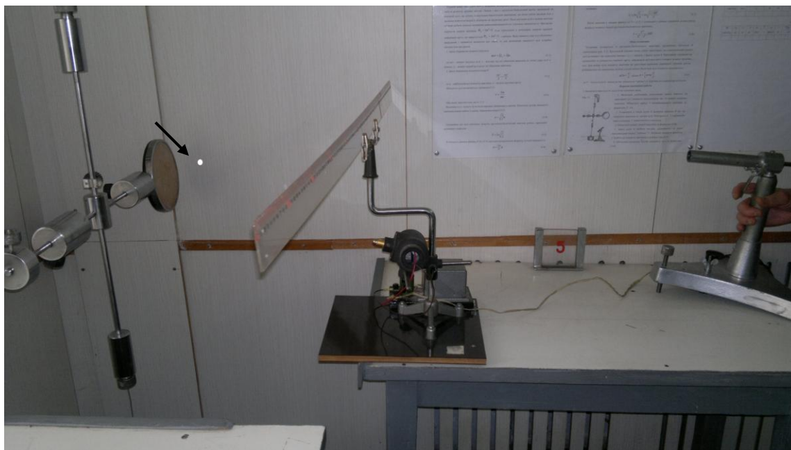
Рис. 3.8. Лабораторна установка для визначення швидкості кулі
