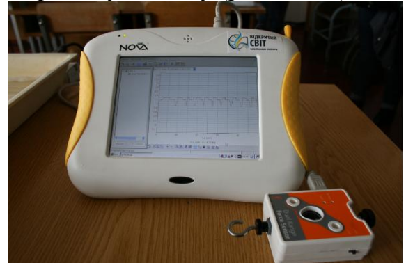
Рис. Ж.2.3. Графік залежності сили розтягу від часу на екрані Nova 5000
