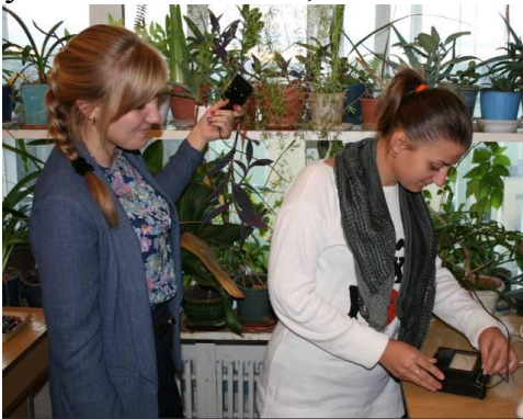
Рис. Ж.2.7. Вимірювання освітленості за допомогою люксметра
