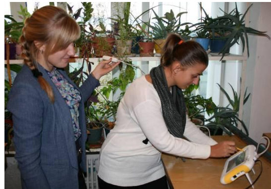
Рис. Ж.2.8. Вимірювання освітленості за допомогою датчика освітленості
