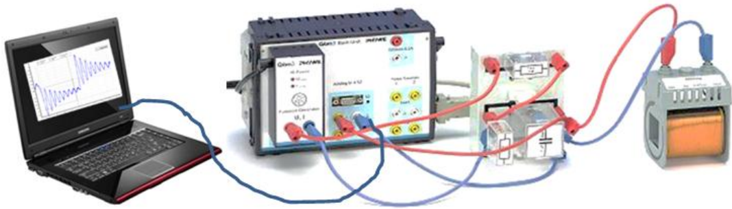
Рис. 2.4. Дослідження коливального контура [136]
