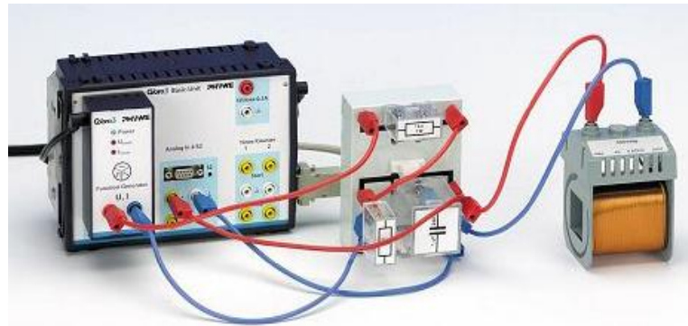
Рис. 2.34. Експериментальна установка: 1 – система «Кобра 3», 2 – вимірювальний модуль «Функціональний генератор», 3 – конденсатори, 4 – котушка із 300 витками
