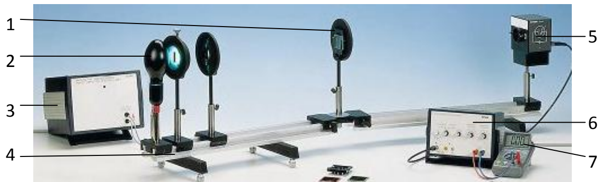
Рис. 2.45. Експериментальна установка для визначення сталої Планка: 1 – тримач для лінзи, 2 – ртутна лампа, 3 – джерело струму, 4 – оптична лава, 5 – фотоелемент з кожухом, 6 – універсальний підсилювач, 7 – цифровий мультиметр
