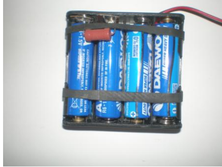
Рис. 2.15. Джерело живлення до лабораторної роботи «Дослідження роботи джерела струму».
