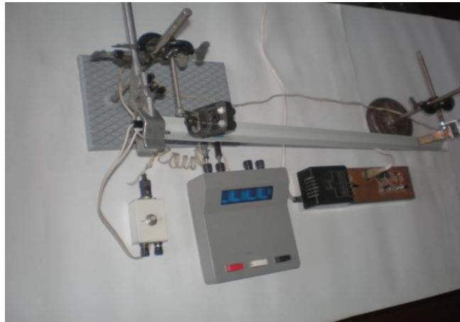
Рис. 2.6. Установка для визначення прискорення рівноприскореного руху кульки.
