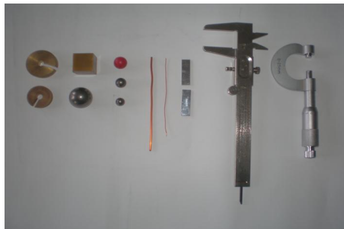
Рис. 2.4. Об'єкти і інструменти для вимірювання їх лінійних розмірів.
