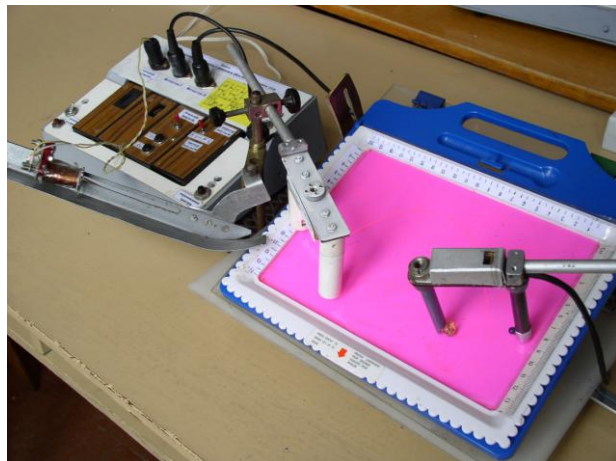
Рис. 2.7. Експериментальна установка для дослідження кінематики руху тіла, кинутого горизонтально, або під кутом до горизонту.
