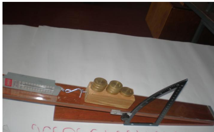
Рис. 2.8. Установка для вимірювання сили і визначення коефіцієнта тертя.
