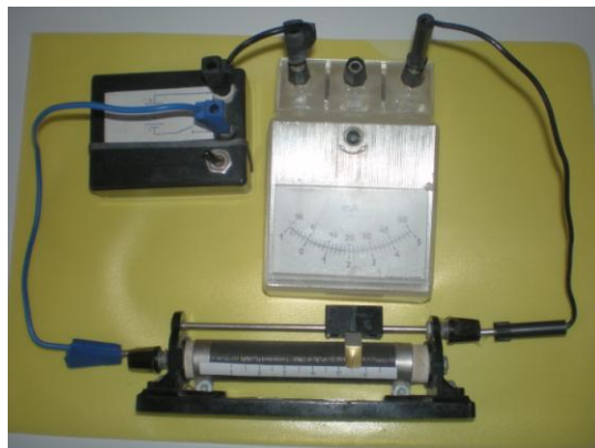
Рис. 2.16. Загальний вигляд експериментальної установки для виконання лабораторної роботи «Дослідження роботи джерела струму».
