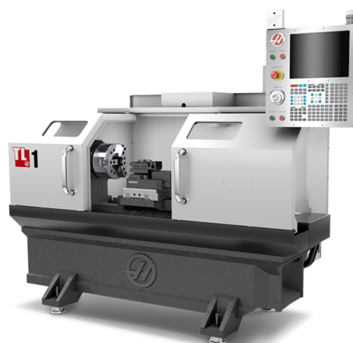
Рис. 2.4.5. токарний верстат Haas TL-1 [324]
