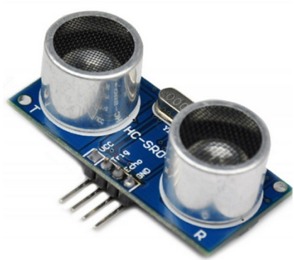
Рис.2.4.14, а. Загальний вигляд датчика HC-SR04
