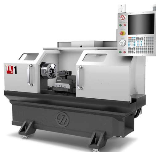
Рис. 2.4.5. токарний верстат Haas TL-1 [324]
