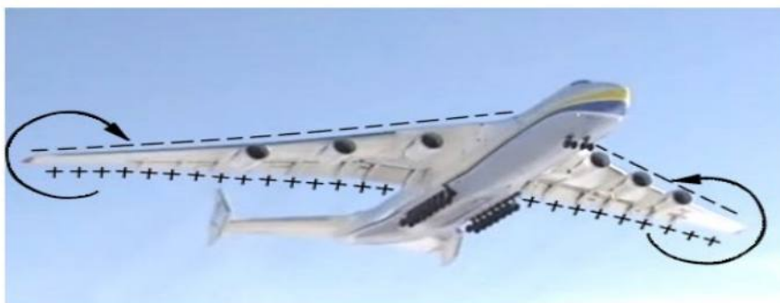
Рис. 4.14. Виникнення вихорів на крилі кінцевого розмаху
