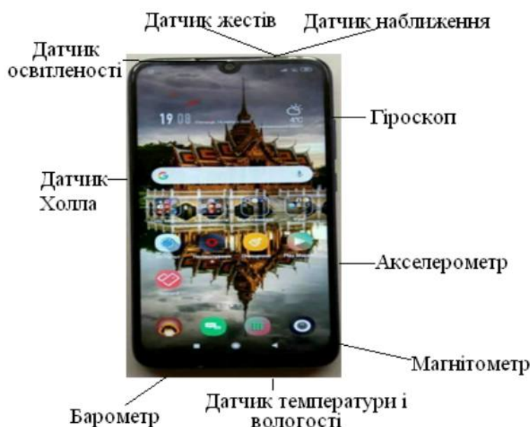
Рис. 3.4. Гіроскоп в смартфоні
