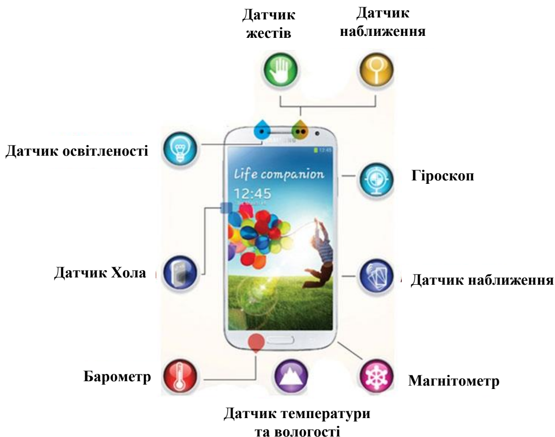
Рис. 2.7. Смартфон – цифровий вимірювальний комплекс
