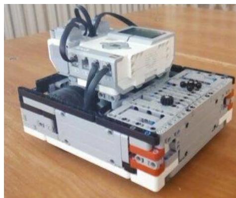
Рис. 2.22. Робот на базі набору LEGO Mindstorms EV3
