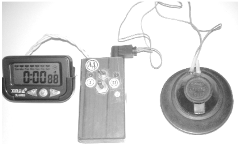
Рис. 1. Загальний вигляд експериментального модуля: секундомір, мікровимикач, акустичний датчик
