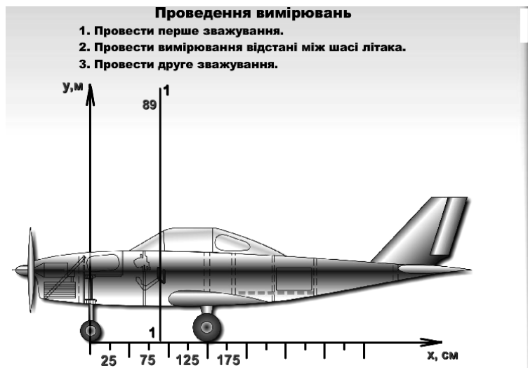
Рис.5. Вимірювання відстані між шасі літака
